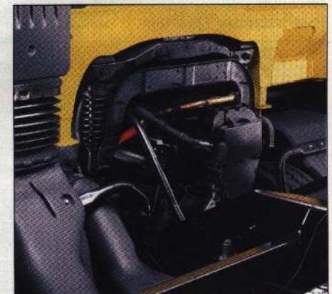
Подвеска кабины механическая с поперечным стабилизатором
