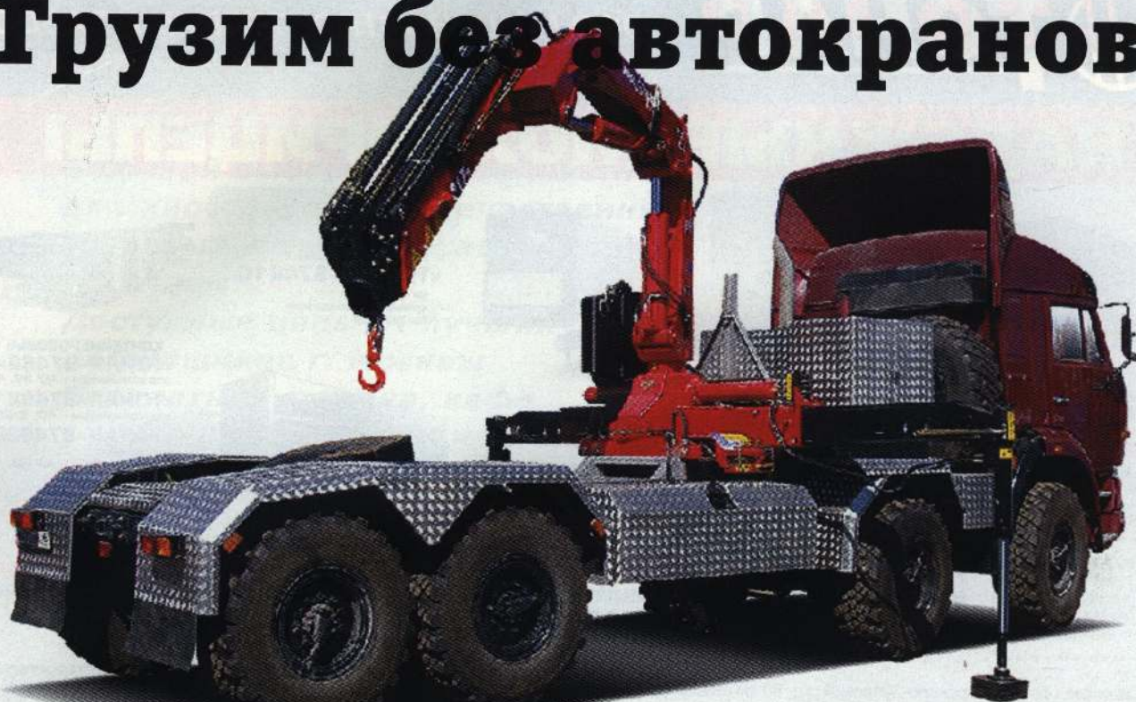
Гидроманипулятор 815 4S на шасси КамАЗа *14 тм, тах г/п 5 т, тах вылет стрелы 12,2 м
