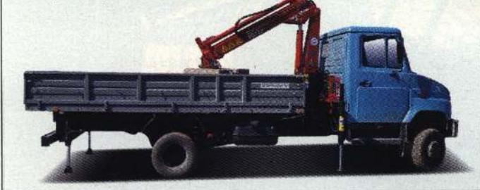
Гидроманипулятор 706 Т 2S на шасси ЗИЛа Бычок *5 тм, тах г/п 2,5 т, тах вылет стрелы 5 м
