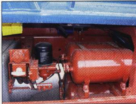
«Масса», блок подготовки воздуха и ресивер объединены в один узел
