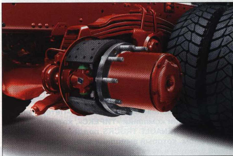
На мостах с планетарными редукторами используются только барабанные тормоза
