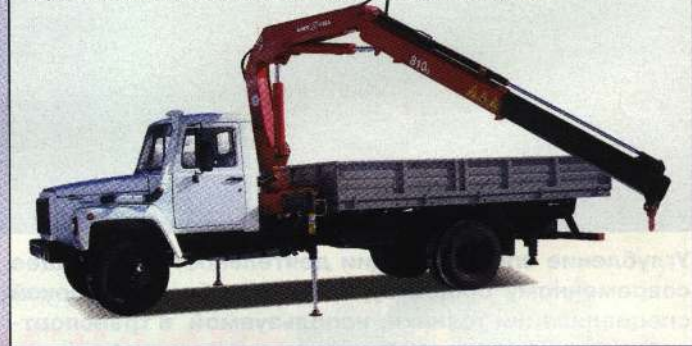
Гидроманипулятор 810 1S на шасси ГАЗ 3309 *9,6 тм, тах г/п 4,2 т, тах вылет стрелы 5,9 м
