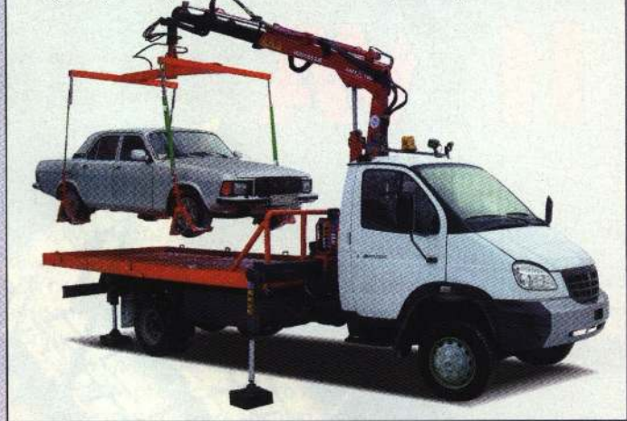
Гидроманипулятор 807 Т 2S на шасси ГАЗ 33104 Валдай *6,9 тм, тах г/п 3,4 т, тах вылет стрелы 5,3 м
