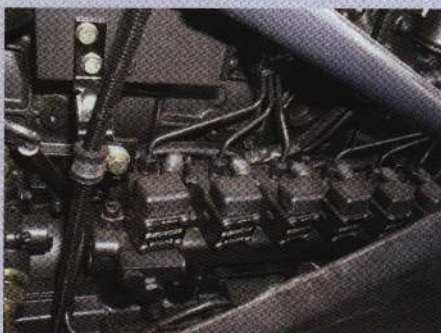
Индивидуальные для каждого цилиндра топливные насосы «Перспектива», построенного специально для российского рынка.
