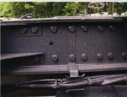
Продольный лонжерон «Перспективы» усилен вставкой
