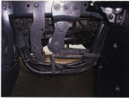
Оплетка нового образца более ремонтпригодна. Для наших дорог «пучок» следует поднять выше
