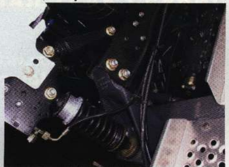
Кабина на механической подвеске
